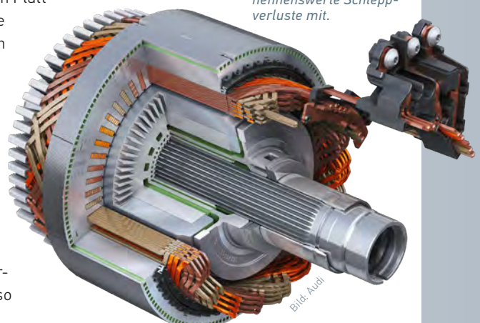
Der ASM mit Hairpin-Wicklung und Ölkühlung an der Vorderachse des Q6 e-tron dreht ohne nennenswerte Schleppverluste mit.
